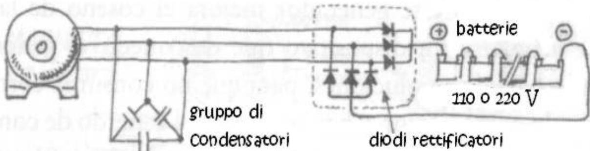
Per caricare batterie, si rettifica la corrente alternata mediante un ponte a 6 diodi (i diodi dell'alternatore di automobile solitamente non servono per sopportare poca tensione opposta e si fondono).
